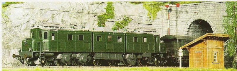
Ae 4/8 der SBB mit Buchli- und Tschanz-Antrieben sowie mit raffinierter Verbindung der Lokteile.
